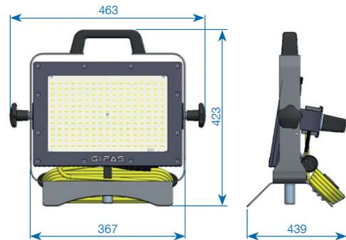
Der Hochleistungsstrahler AlphaLUXX wird standardmässig mit einem Montagebügel geliefert. Zur Optimierung für verschiedene Einsatzmöglichkeiten hat GIFA5 einen Ständer mit Befestigungszapfen entwickelt. Dieser ermöglicht ein einfaches und schnelles montieren auf den Ständer. Ebenso bietet dieser Ständer einen zweiten Nutzen, indem die AlphaLUXX einfach auf dem Boden platziert werden kann.
